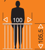
Kit für gerade Schutzgeländer (1 kit = 1 m)
